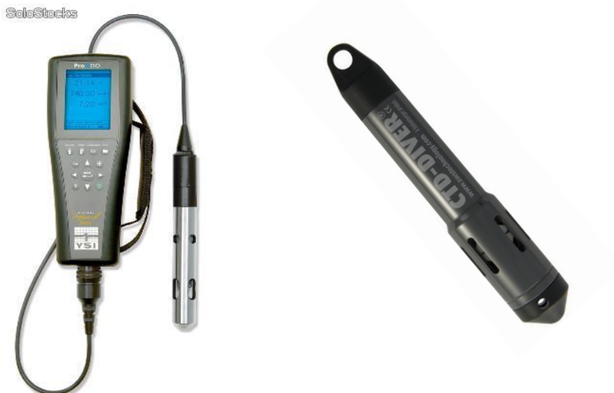
Figure 8 : Exemple de sonde thermosalinomètre utilisées pour les mesures in situ – YSI et Diver
