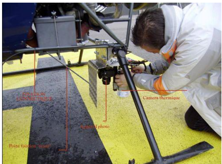
Figure 4 : hélicoptère Robinson R22 équipé du système de fixation des différents instruments de mesures
