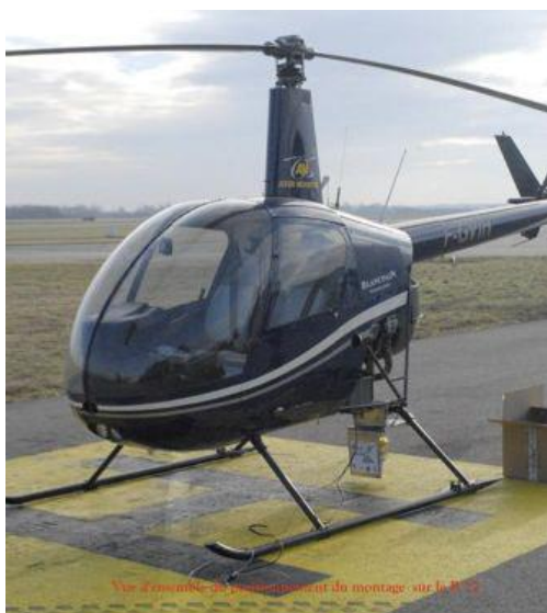
Figure 4 : hélicoptère Robinson R22 équipé du système de fixation des différents instruments de mesures
